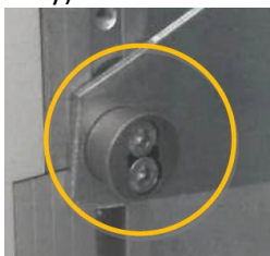
Rys. 58 Tuleja LB 18-2-SL13-2xM5x16.
